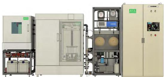
減圧蒸気スイング型CO<sub>2</sub>回収装置（モデル図）
