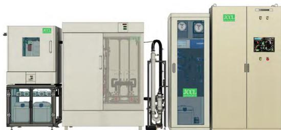
減圧蒸気スweep型膜分離性能評価装置（モデル図）
